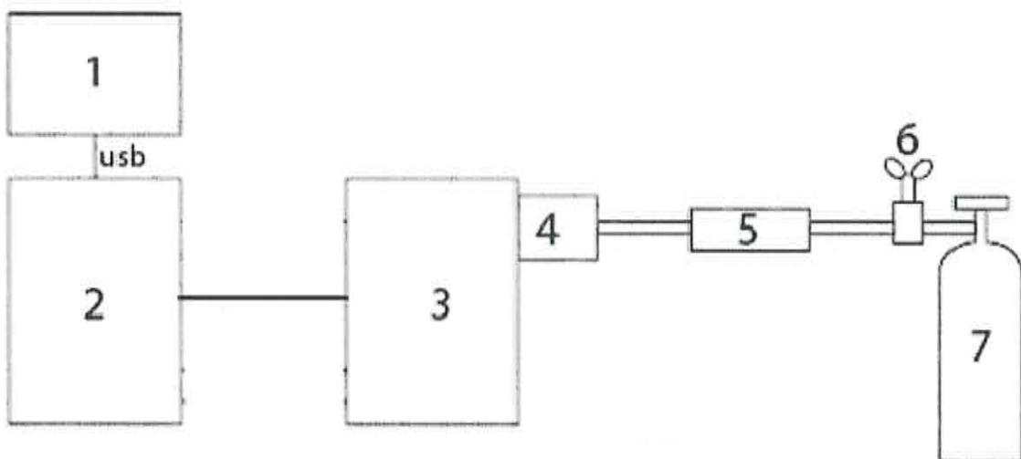
Рисунок Б.1 - Рекомендуемая схема подачи ГС из баллонов под давлением на вход преобразователя
